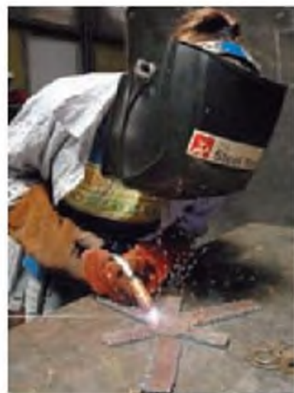
▲ Figura 22.16 Soldadura con un soplete de oxiacetileno. El calor de combustión del acetileno es excepcionalmente elevado, por lo cual se alcanza una temperatura de flama muy elevada.
